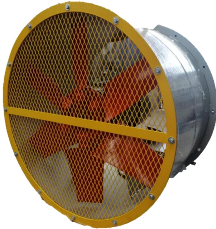
Los extractores tubo axiales fabricados en **A & M Partes y Climas**, están accionados por transmisión de polea y banda con motor exterior al flujo de aire para poder transportar gases a mayor temperatura o aire con partículas. Pueden instalarse de manera horizontal o vertical.
